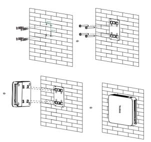
固定挂墙架前,需确认MCore要安装的方向,挂墙架一旦固定,MCore的安装方向随之固定。
